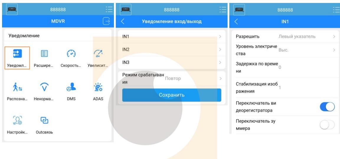
Камера ADAS поддерживает функции обнаружения 4-х тревог: опасность столкновения, съезд с полосы движения, обнаружение пешеходов и опасное сближение. Любую из этих тревог можно отключить или перенастроить.
