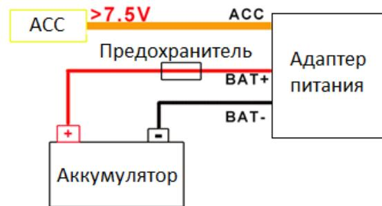
*Примечание: при тестировании устройства, подключите оба провода – красный и оранжевый к положительному полюсу источника питания, в противном случае устройство не включится.*
