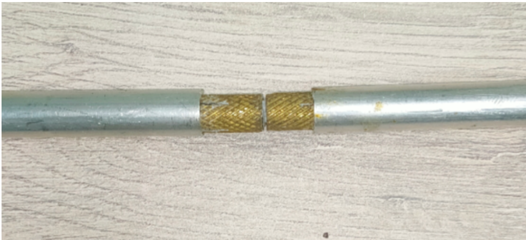
Внутреннее соединение цангового соединения
