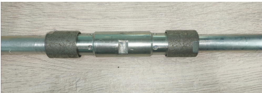
Цанговое соединение установлено
