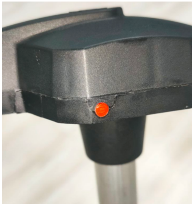
Установленная пломба на проводной дут
