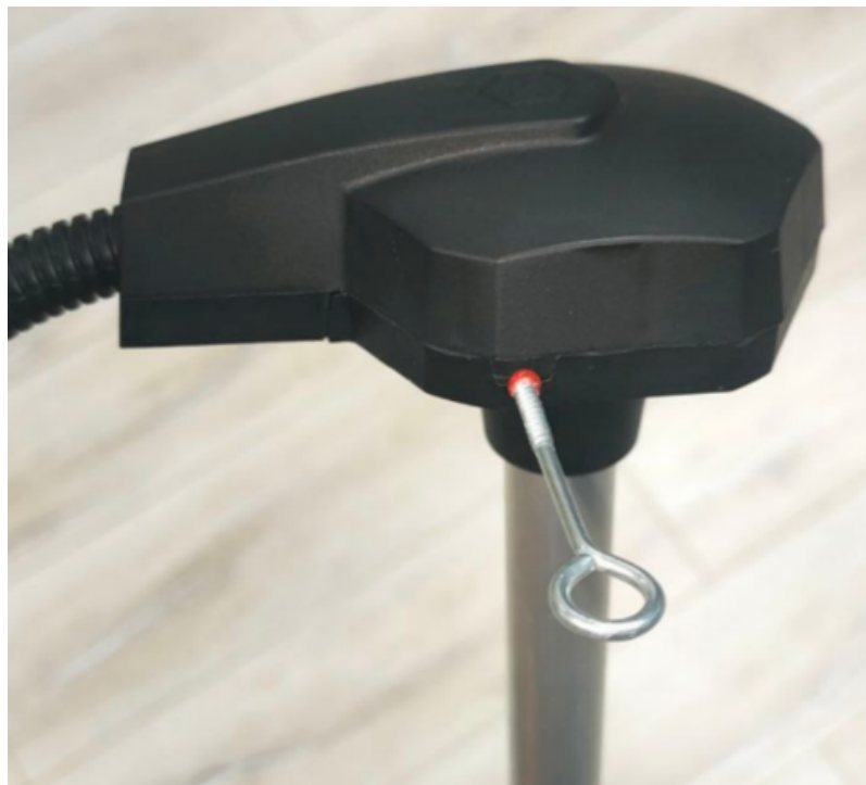
Извлечение пломбы проводного дут
