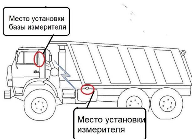
Рис. 6.1. Примерная схема установки
