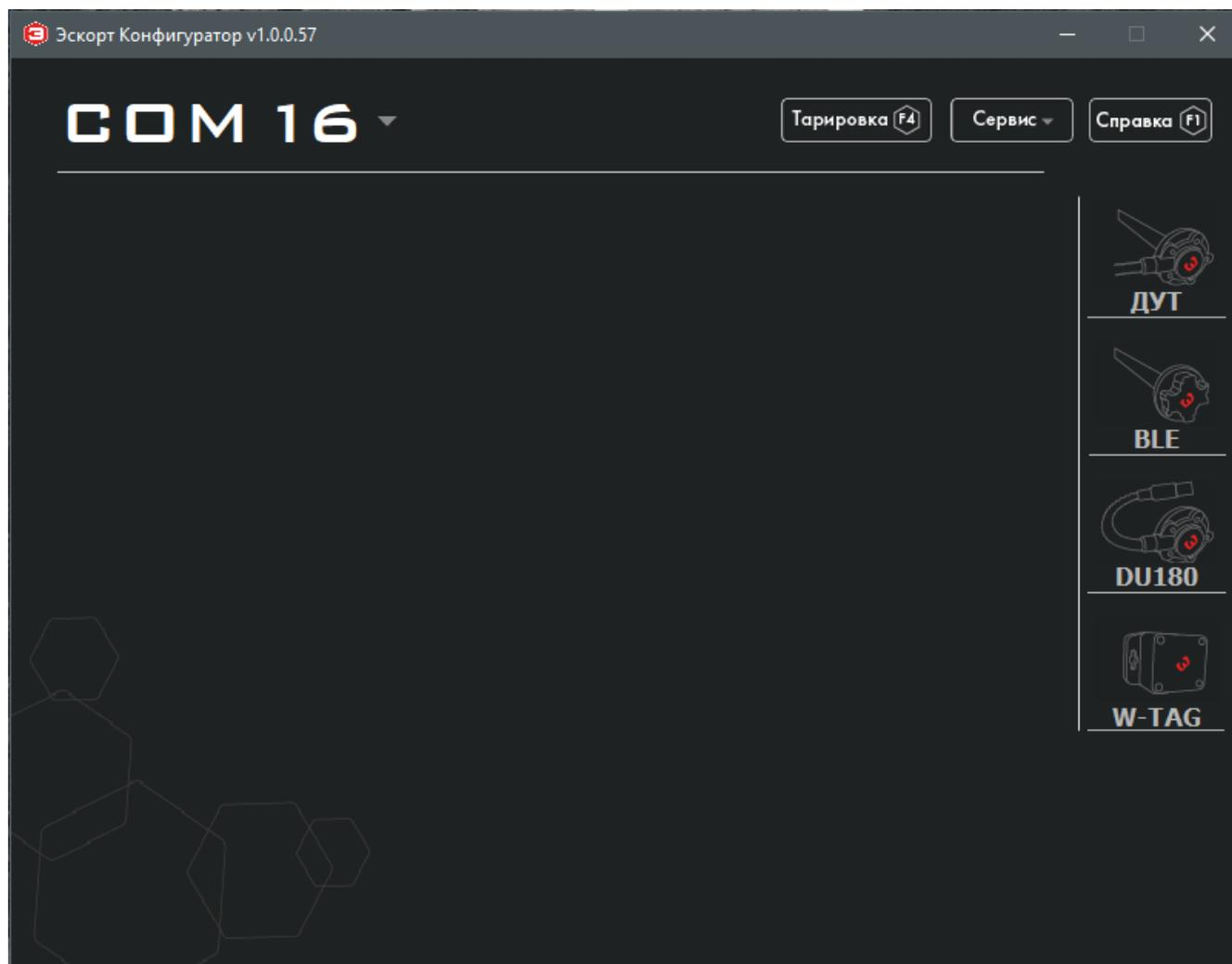
**Для подключения датчика TD BLE для настройки необходимо подключить к ПК устройство BLE-BASE-USB. В конфигураторе выбрать определившийся ком порт, затем нажать на иконку BLE.**
