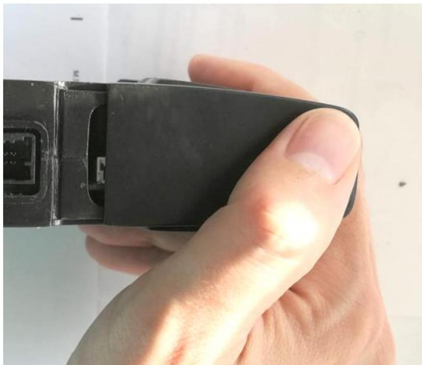
Рисунок 4.1 Открытие отсека АКБ
