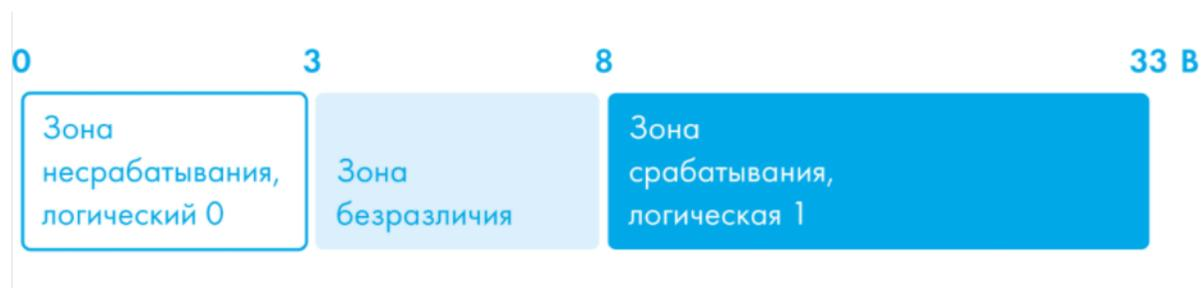
То, терминал будет непрерывно вычислять среднее значение и занесение данного значения в поле **IN0**. Одновременно с вычислением среднего происходит проверка принадлежности вычисленной величины диапазонам логического нуля и единицы.
