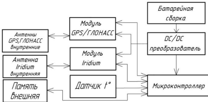
Рис.3 Функциональная схема устройства.
