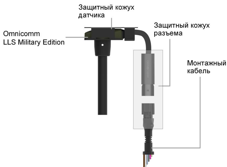
При необходимости удлинения монтажного кабеля используйте кабель КТЗ-МХ (10, 15, 20 метров). Допускается использование только одного кабеля КТЗ-МХ.
