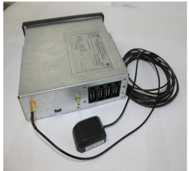
Рисунок 1.1 – Общий вид тахографа цифрового ТЦА-02НК
