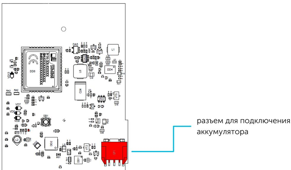
Если элемент питания был извлечен, или его требуется заменить, то перед началом работы с устройством необходимо установить элемент питания в предназначенный для этого слот. Для
